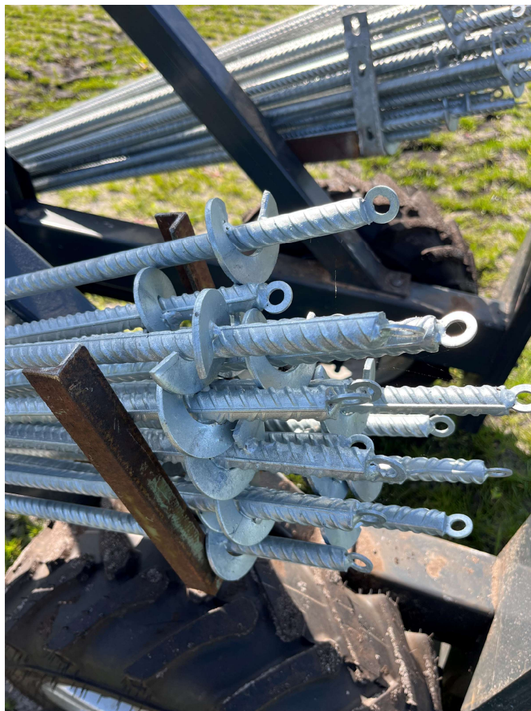
Nærbillede – Solar42 med galvaniserede stålpæle med snegleforskruning til iboring
